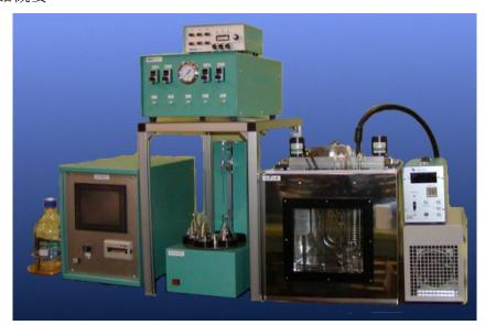
高分子化学分野では種々の動粘度測定(毛管粘度計など、細い管のなかを自重で通過する速度(時間)で比較する絶対粘度を密度で割った動粘度)が行われています。動粘度の測定には、ガラス製毛管式粘度計を使用するものがあります。測定の原理は、一定容量の液体が管理された温度条件下において、粘度計の毛管中を自然落下するのに要した時間を計測して、計算式により求めます。これらの操作を手動で行うと、手間が掛かる上に、溶液の量や測定時間が安定せず、結果として測定粘度に誤差が生じてしまうために自動測定が求められています。
