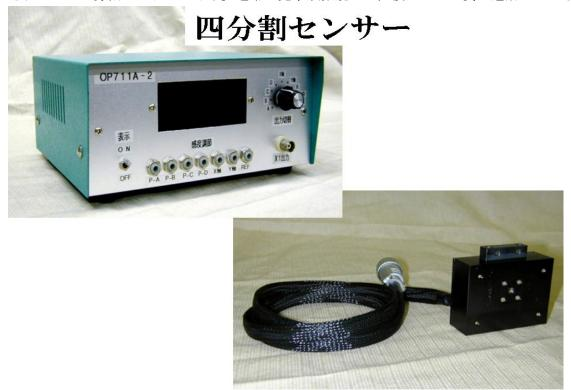
ところは観察できるのですが、その分解能は可視光の波長程度です〈可視光線の波長は約0.35~0.8 ミクロン(1ミクロン=1000 分の1ミリ)〉そこで四分割フォトダイオードを用いナノメーターレベル(100万分の1mm)の計測を可能とするために開発されたのがこの装置です。この方法により一例として回転するモーターであるバクテリア鞭毛の微細な動きが観察できます。近年飛躍的にこの分野が開けてきた原動力の装置であり一分子計測には無くてはならない装置です。また科学技術事業団の柳田生体運動子プロジェクトというこの分野での先駆者的プロジェクトからスタートしそのプロジェクトとともに成長してきた装置でもあります。
